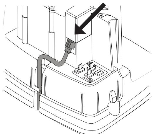
Entfernen Sie die Schutzabdeckung der Ladestation, indem Sie die Laschen auf jeder Seite der Basis eindrücken und die Abdeckung abnehmen.
