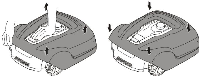
Hold plæneklipperen nede med den ene hånd, og løft med et fast tag et hjørne af kabinetet, og gentag for alle fire hjørner, indtil kabinetet løsner sig fra chassiset.
