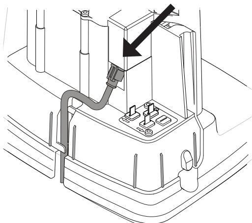
Csatlakoztassa a kisfeszültségű kábelt a töltőállomáshoz.
