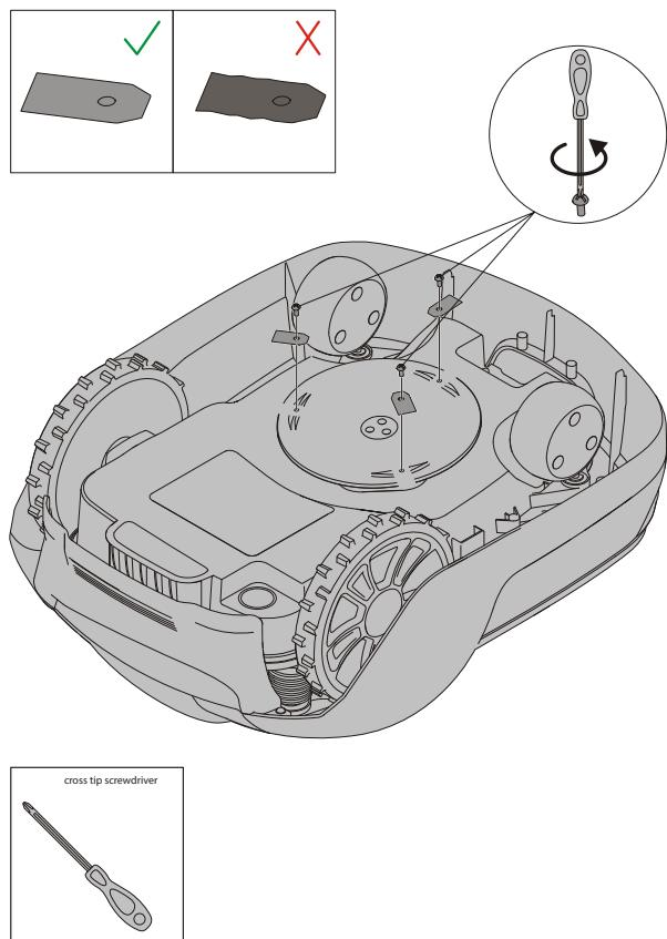
**AVVERTENZA!** Premere il tasto STOP e rimuovere la chiave di sicurezza prima di sostituire le lame e indossare guanti di protezione.
