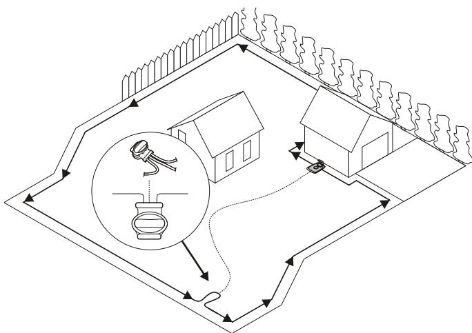
O corta-relva usa o fio-guia opcional para encontrar o seu caminho de volta para a estação de carregamento, mas também encontra áreas de difícil alcance da área operacional. Por exemplo, o fio-guia é colocado entre o carregador e uma parte remota da área de trabalho ou através de uma passagem estreita.
