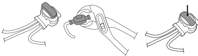
Sæt de to ender af afgrænsningskablet samt enden af styrekablet ind i samleren og stikket til styrekabel. Kontrollér, at kablerne er skubbet helt ind i samleren og stikket til styrekablet, så enderne synligt går gennem samleren og stikket til styrekablet.
