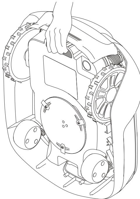
Drücken Sie die **STOP**-Taste und ziehen Sie den Sicherheitsschlüssel ab, bevor Sie den Mäher anheben.
