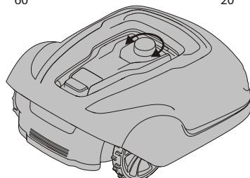
I de første par uger sættes klippehøjden til 60 mm for at undgå at klippe i afgrænsningskablet og styrekablet. Sænk indstillingen af klippehøjden et trin i de følgende uger, indtil den ønskede klippehøjde er nået.
