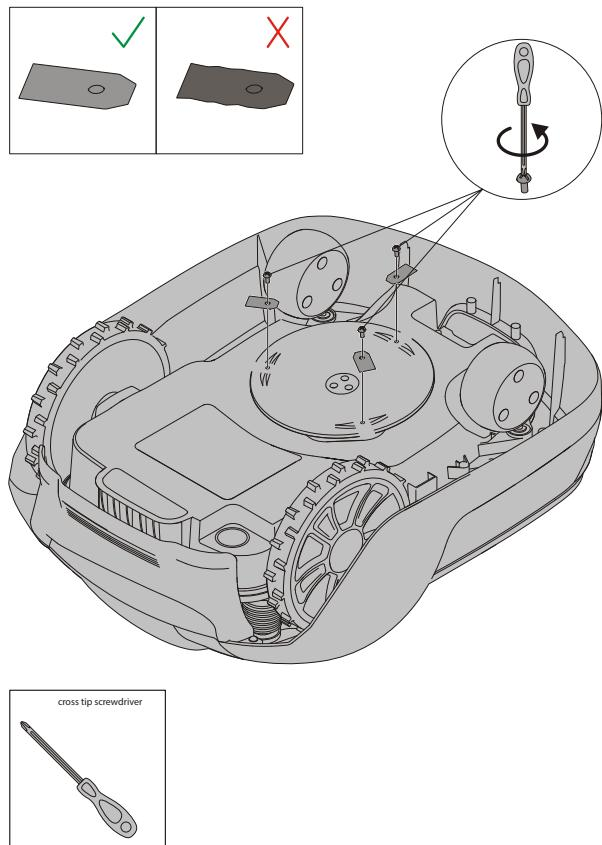
**¡ADVERTENCIA!** Pulse el botón de PARADA y retire la llave de seguridad antes de sustituir las cuchillas y lleve guantes de protección.
