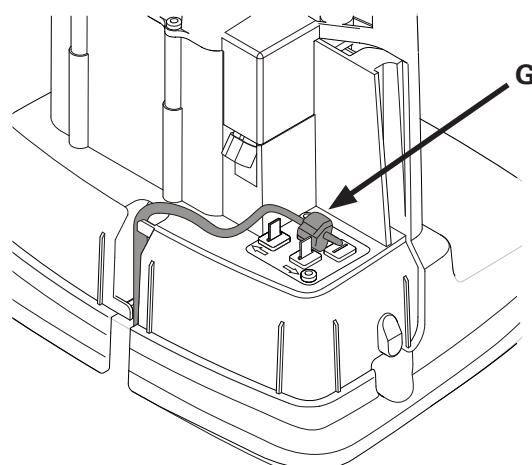
Przewód prowadzący należy podłączyć do stacji ładowania w następujący sposób:
