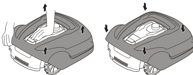
Houd de grasmaaier met één hand tegen de grond en trek stevig aan een van de hoeken van de romp. Herhaal deze handeling voor alle vier de hoeken totdat de romp van het chassis loskomt.
