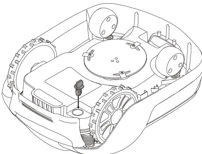
Vložte bezpečnostný kľúč do spodnej časti kosačky a otočte do polohy **Enable** (Povoliť).
