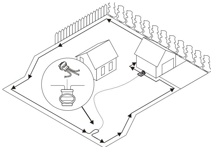
Косачката използва опционален направляващ проводник, за да отваря своя път обратно към зарядното устройство, но и за откриване на трудно достъпни участъци на работната зона. Например, направляващият проводник се полага между зарядното устройство и отдалечена част на работната зона или през тесен проход.
