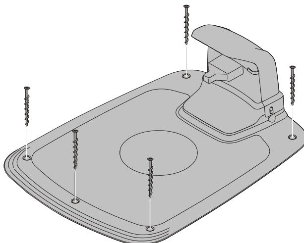
Закрепете зарядното устройство към земята с петте доставени фиксиращи винта като използвате шестостенен ключ 6 mm.
