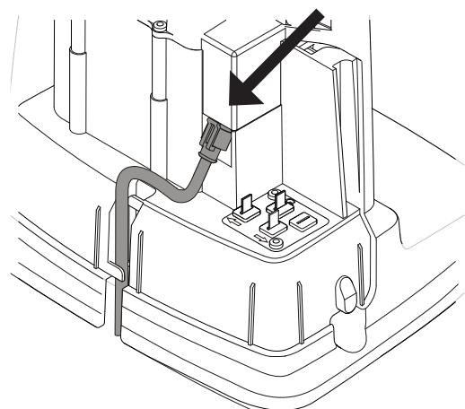
Connectez le câble basse tension à la station de charge.
