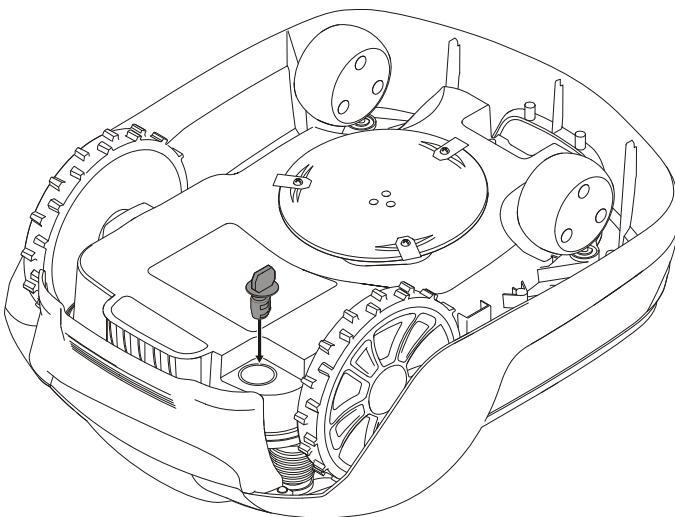
Inserire la chiave di sicurezza nella parte inferiore dell'apparecchio e ruotare la **Attiva**.
