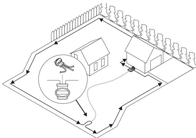
Kosilica se služi žicom vodilicom koja je dodatna oprema kako bi našla put prema stanici za punjenje, ali za nalaženje teško dostupnih dijelova radnog područja. Primjerice, žica vodilica se položi između stanice za punjenje i udaljenog dijela radnog prostora ili kroz uski prolaz.
