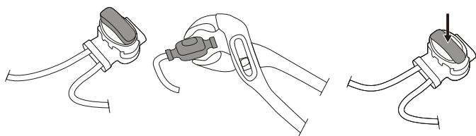
Om begränsningskabeln är för kort ska du använda de medföljande skarvorna och guidekabelkopplingarna för att skarva ytterligare begränsningskabel på följande sätt:
