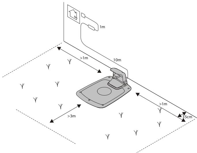
Pozitionarea stației de încărcare după cum urmează:
