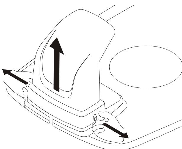
Zdjąć pokrywę ochronną na stacji ładowania: w tym celu wcisnąć zaczepy po obu stronach podstawy i podnieść pokrywę.
