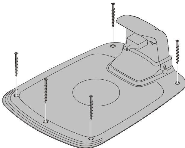
Arrimez la station de charge au sol avec les cinq vis de fixation fournies à l'aide d'une clé hex de 6 mm.
