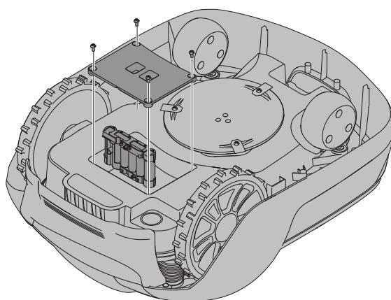
**UPOZORENJE!** Pritisnite gumb STOP i izvadite sigurnosni ključ prije zamjene baterija i nosite zaštitne rukavice.
