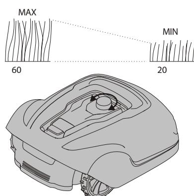
Během prvních několika týdnů sekání nastavte výšku sekání na 60 mm, aby nedošlo k přeřezání ohraňujícího drátu a vodicího drátu. Poté každý týden snižte nastavení o jeden krok, až dosáhnete požadované výšky sekání.
