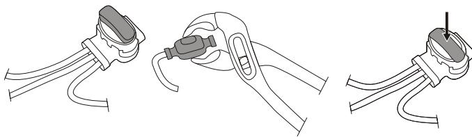
Inserire entrambe le estremità del cavo e gli estremità del filo di guida nella splice e guidare il filo. Controllare che i cavi siano ben inserita nella Guida connettore splice e in modo che le estremità sono visibili attraverso l'guida splice e connettore.
