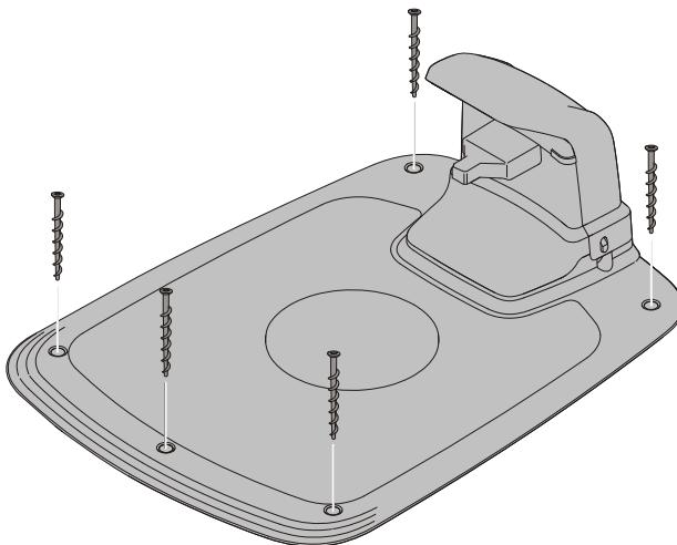
Fissare la stazione di ricarica al suolo con cinque viti di fissaggio fornito con una chiave esagonale 6 mm.
