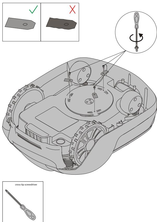
**VARNING!** Tryck på STOPP-knappen och ta ur säkerhetsnyckeln innan du byter ut knivarna. Använd skyddshandskar.
