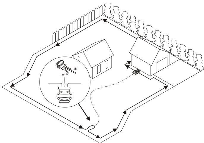
Kosiarka wykorzystuje opcjonalny przewód prowadzący, za pomocą którego odnajduje drogę powrotną do stacji ładowania, przewód prowadzący też znalezienie trudno dostępne fragmenty terenu w strefie pracy. Na przykład, przewód prowadzący może zostać położony między stacją ładowania a odległą częścią strefy pracy lub w wąskim przesmyku.
