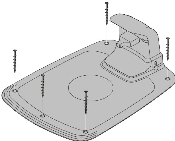
Fije la estación de carga al suelo con los cinco tornillos de fijación suministrados con una llave hexagonal de 6 mm.
