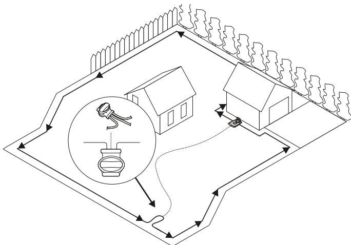
Mit dem optionalen Führungsdrat findet der Mäher den Weg zurück zur Ladestation, aber auch schwer zugängliche Bereiche des Betriebsbereichs. So wird beispielsweise der Führungsdrat zwischen der Ladestation und einem abgelegenen Teil des Arbeitsbereichs oder durch einen engen Durchgang verlegt.
