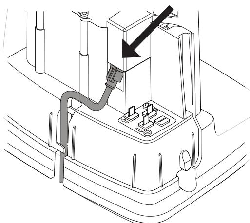
Podłączyć kabel niskonapięciowy do stacji ładowania.
