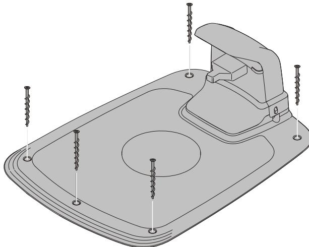
Fixați stația de încărcare de sol utilizând cele cinci șuruburi de fixare incluse cu ajutorul unei chei hexagonale de 6mm.
