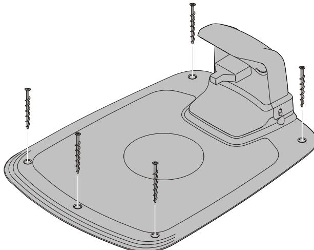
Zamocować stację ładowania do podłożu za pomocą pięciu dostarczonych śrub mocujących, użyć klucza imbusowego 6 mm.
