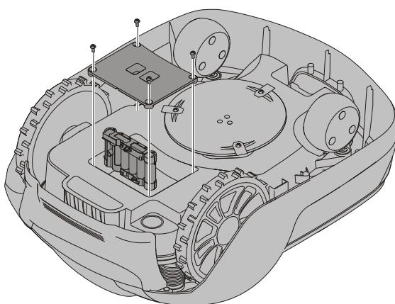
**WARNUNG!** Drücken Sie die STOP-Taste und ziehen Sie den Sicherheitsschlüssel ab, bevor Sie Akkus austauschen.
