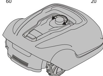
Para as primeiras semanas de corte, defina a altura de corte para 60 mm para evitar cortar o fio de delimitação e fio-guia. Reduza a configuração um passo a cada semana daí em diante até atingir a altura de corte desejada.
