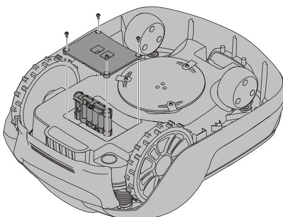
**VAROVÁNÍ!** Stiskněte tlačítko STOP a před výměnou baterie vyjměte bezpečnostní klíč; použijte ochranné rukavice.
