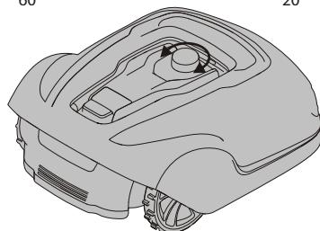
Sett klippehøyden til 60 mm de første ukene med gressklipping for å unngå å kutte grense- og ledekabelen. Senk innstillingen ett trinn hver uke etter dette til du har nådd ønsket klippehøyde.
