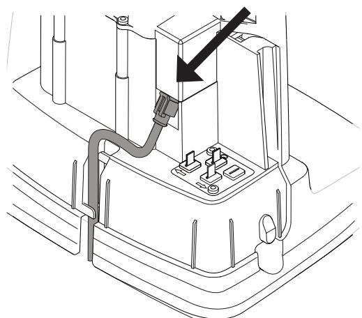
Conecte el cable de baja tensión a la estación de carga.
