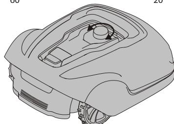
Stellen Sie in den ersten Wochen des Mähens die Schnitthöhe auf 60 mm ein, um das versehentliche Durchtrennen von Begrenzungsdraht und Führungsdraht zu vermeiden. Nachfolgend stufenweise jede Woche einen Schritt tiefer einstellen, bis die gewünschte Schnitthöhe erreicht ist.
